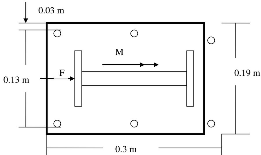
**Figura 5.22** Ubicación y dimensiones de placa de anclaje.
