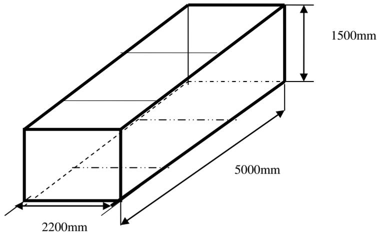
**Figura 5.36** Tanque de enfriamiento de mango con sus dimensiones.
