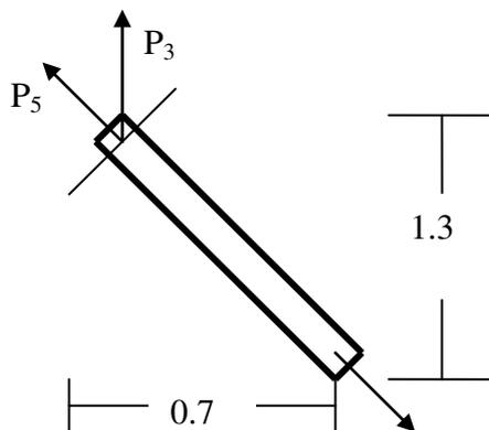
**Figura 5.6** Diagrama y descomposición de fuerzas en perfil 5
