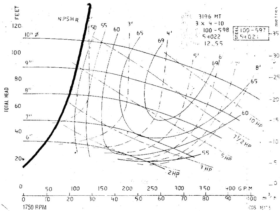
**Figura 5.37** Curvas del modelo de bomba para tanque de enfriamiento.
