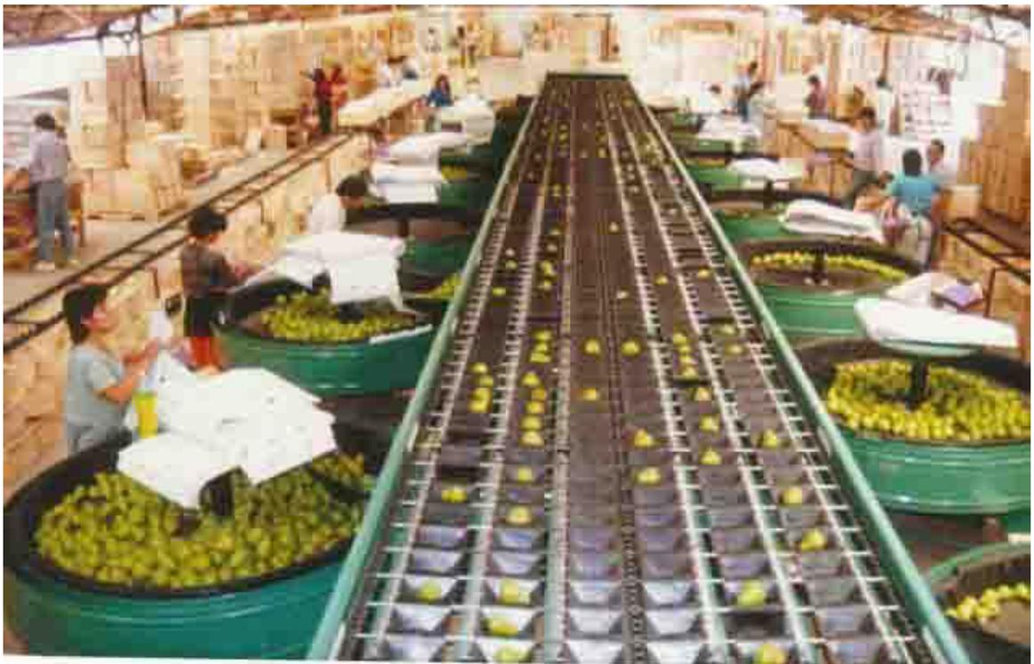
**Figura 4.4** Calibrador electrónico para selección de fruta
