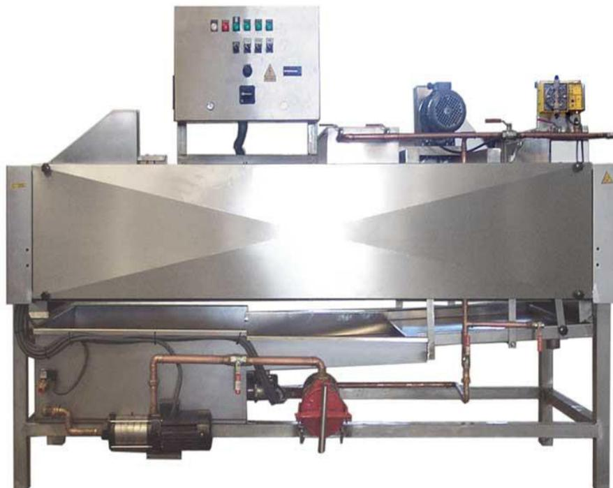
**Figura 4.1** Gráfico de lavadora de mangos en funcionamiento.
