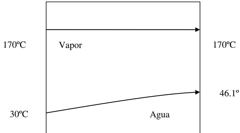
**Figura 5.28** Distribuciones de temperatura para el intercambiador.
