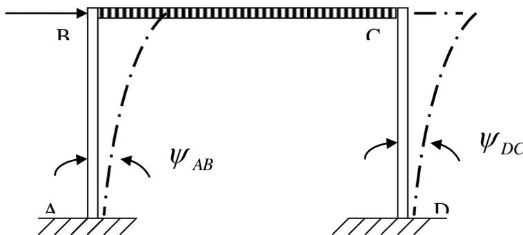
**Figura 5.15** Ángulos de inclinación de las columnas
