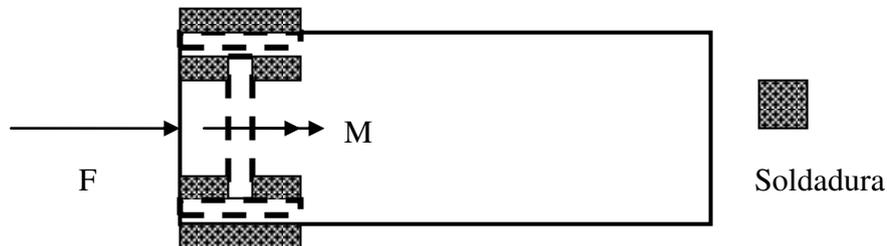
**Figura 5.20** Diagrama de soldadura entre viga soporte y columna.
