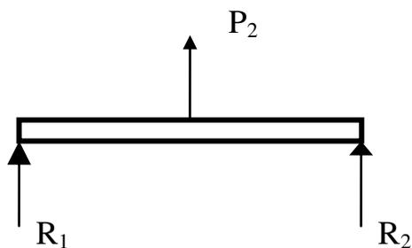
**Figura 5.3** Diagrama de fuerzas de perfil 2 del bastidor
