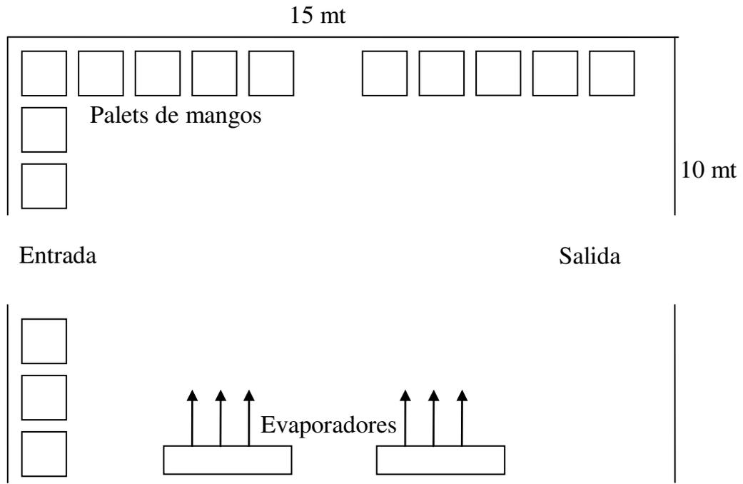
**Figura 5.41** Dimensiones del cuarto para el almacenamiento de cajas.
