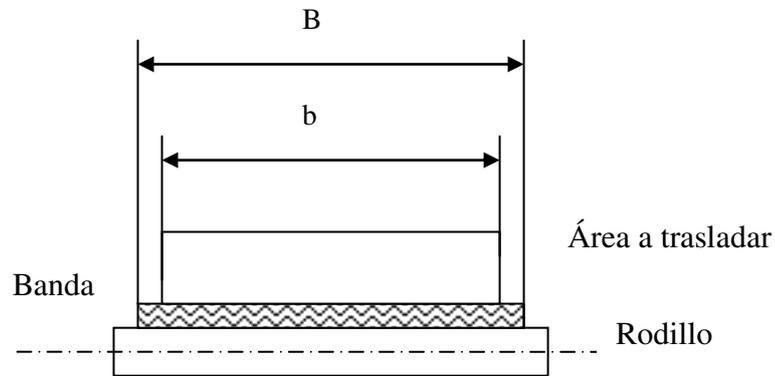
**Figura 5.39** Gráfico para cálculo de ancho de banda.
