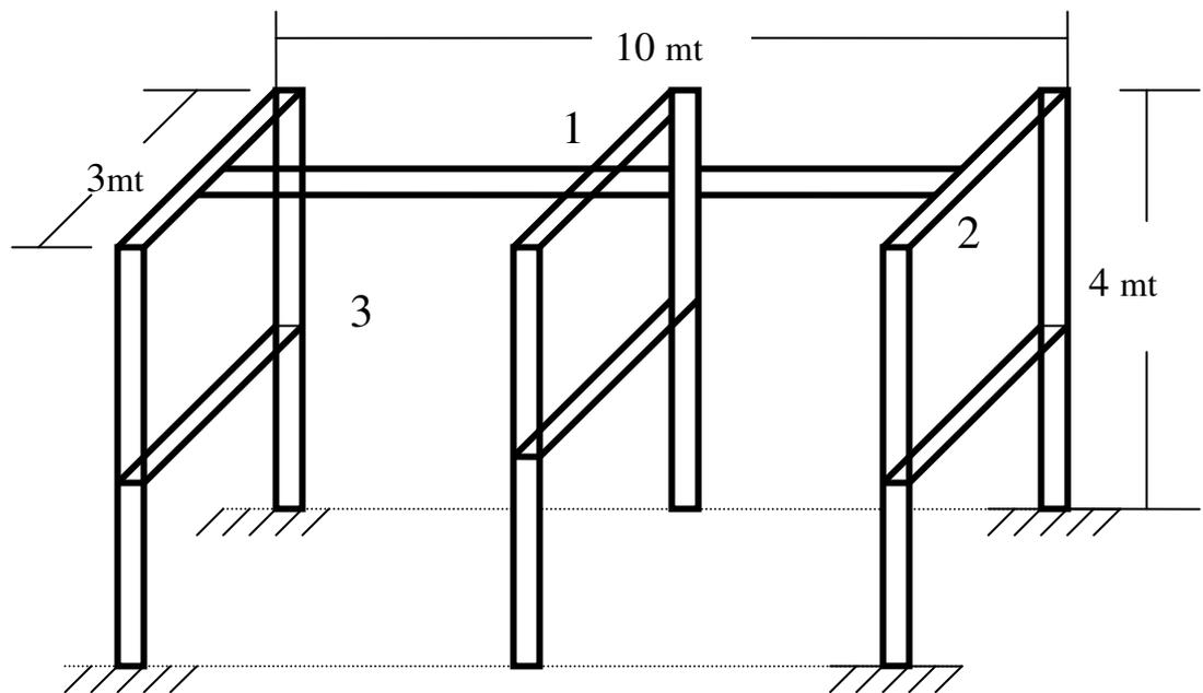
**Figura 5.10** Pórtico Grúa para transporte de jaulas
