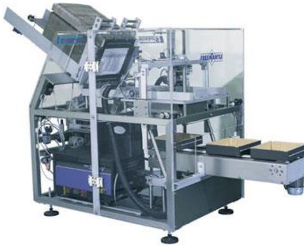
**Figura 4.6** Equipo formador de cajas de cartón para empacado.
