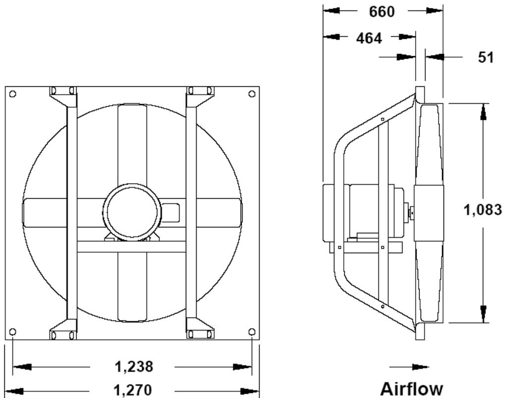
**Figura 5.35** Dimensiones del ventilador seleccionado para el secado.
