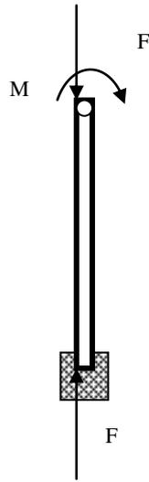
**Figura 5.18** Diagrama de fuerzas resultantes sobre columnas.
