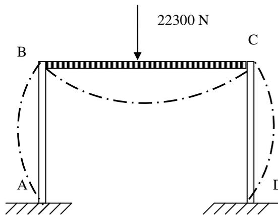
**Figura 5.14** Esquema de deflexión de los perfiles
