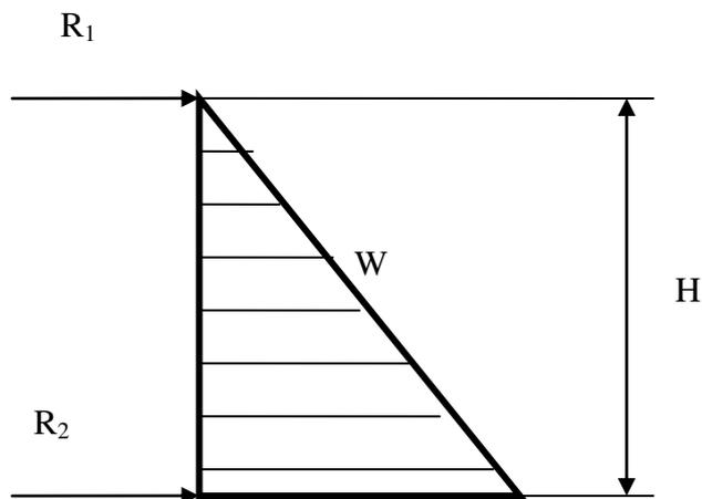
**Figura 5.25** Diagrama de reacciones sobre pared del tanque.
