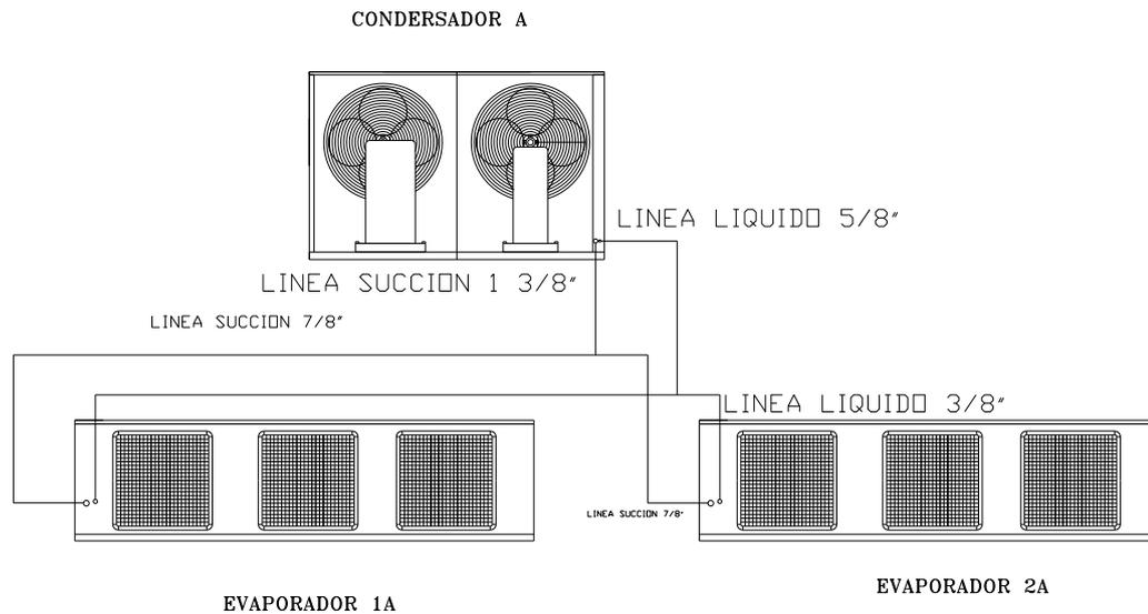
**Figura 5.44** Esquema de conexión de líneas de refrigeración para la cámara.
