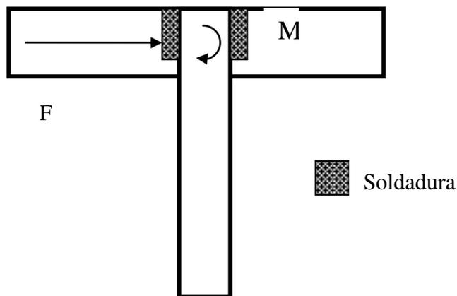
**Figura 5.19** Soldadura de Viga Carril con Viga Soporte
