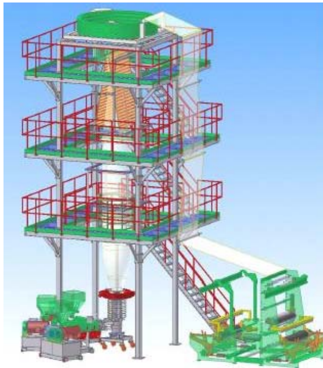
FIGURA 3.13 TORRE DE 3 PISOS PARA COEXTRUSION
