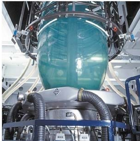
FIGURA 3.9 CABEZAL PARA COEXTRUSION DE 3 CAPAS
