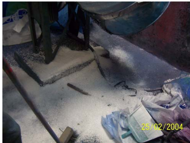
FIGURA 2.31 CONTAMINACIÓN DE PELLETS
