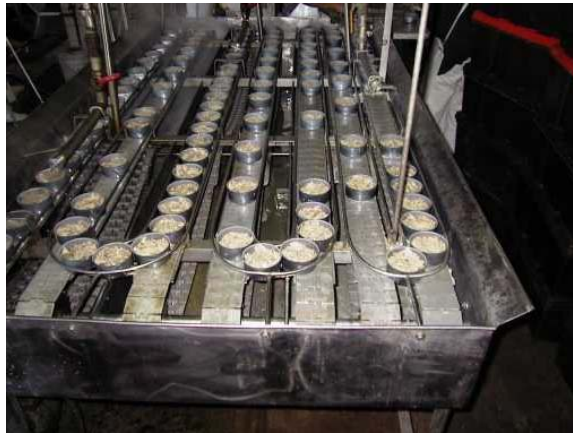
Fig. 15 Adición de líquido de cobertura
