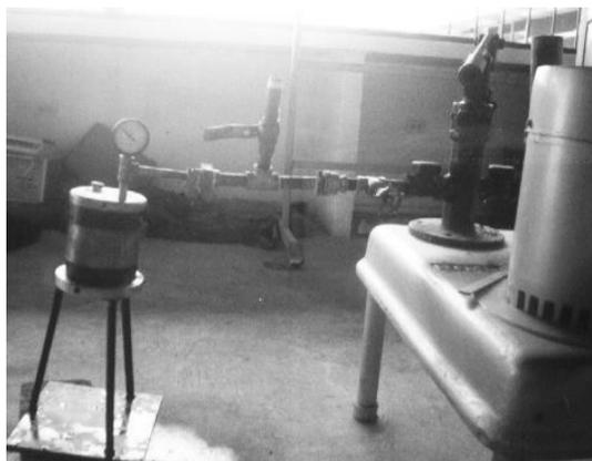
Fig.2.5. Prueba hidrostática de recipiente a presión PV-S 04
