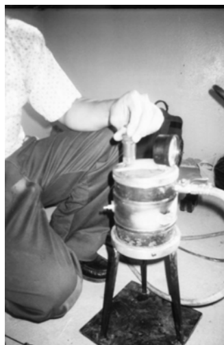
Fig.2.6. Prueba neumática: Detección de fugas en accesorios y calibración de válvula de alivio.
