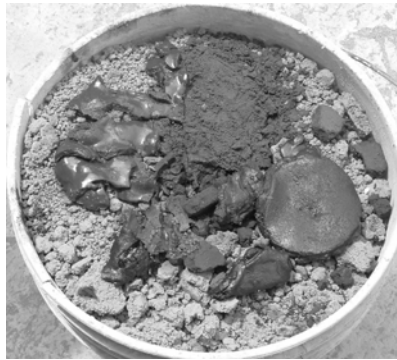
Fig.2. 8. Compactaciones del lecho a granulometrías de 45 \mu\text{m} (lado derecho) y 75 \mu\text{m} (lado izquierdo).
