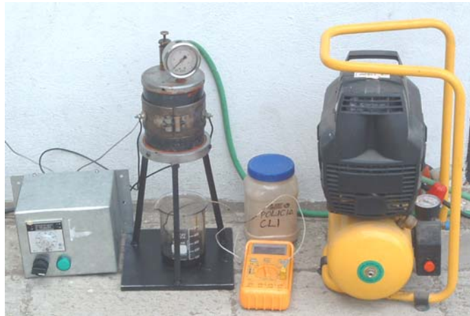
Fig.2.3. Equipo experimental para la evaluación de aceites usados
