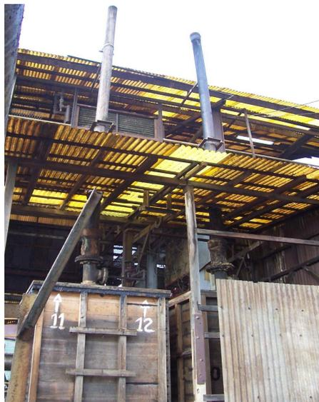
**Figura 1.5. Torres de Sulfatación**
