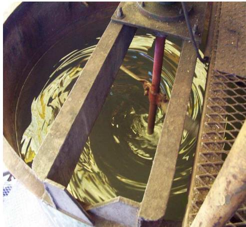
**Figura 1.13. Preparación del floculante**
