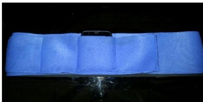
Figura 3.8: Prototipo de la montura del dispositivo móvil
