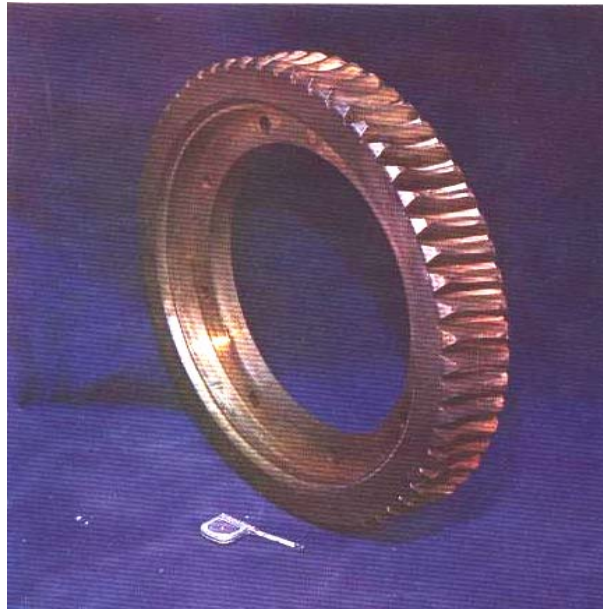
Fig. 1.1.- Rueda para tornillo sin-fin corona. Bronce al estaño ( 87 Cu, 11 Sn, 2 Ni ).
