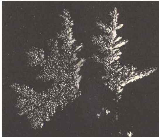
Fig. 1.10 .- Crecimiento de dendritas en el magnesio líquido
