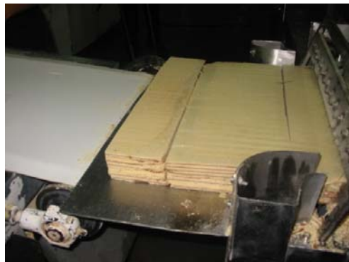
Figura 3.14. Corte de obleas wafer antes de la mejora del equipo 16
