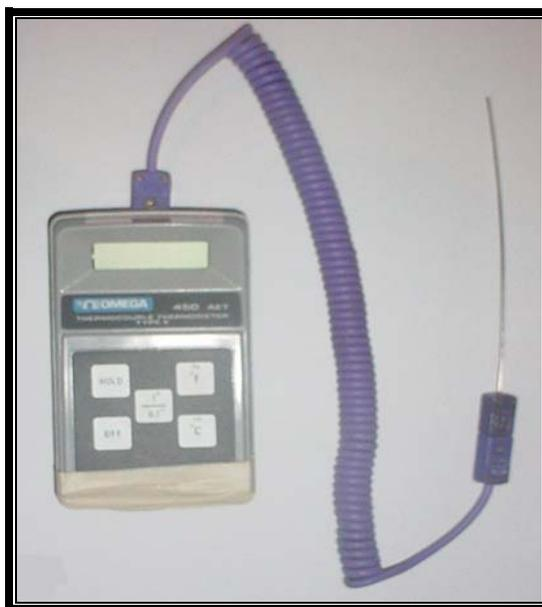
**Figura 2.10: Medidor de la temperatura ambiente**
