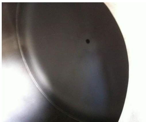
Figura A-27. Superficie interior después de SSPC-SP 5
