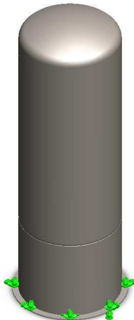
Figura 3-3. Sujeción del recipiente
