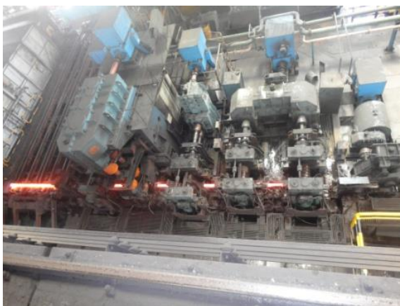
FIGURA 1.4 VISTA SUPERIOR LÍNEA DE PRODUCCIÓN LAMINACIÓN.
