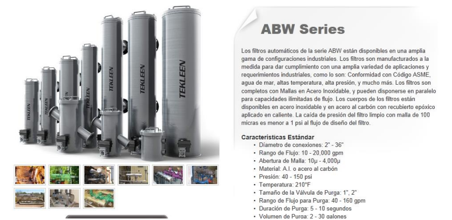
FIGURA 2.42 SERIE ABW FILTRO TEKLEEN [22].
