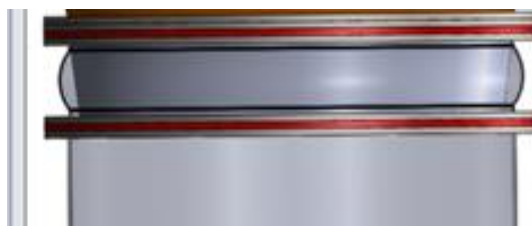
FIGURA 2.24 DISEÑO DE JUNTA DE EXPANSION DE 1700 MM
