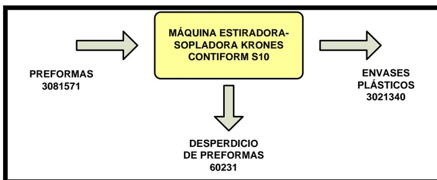
**FIGURA 3.4. BALANCE DE CANTIDAD DE PREFORMAS PRODUCIDAS EN UN MES DE TRABAJO**
