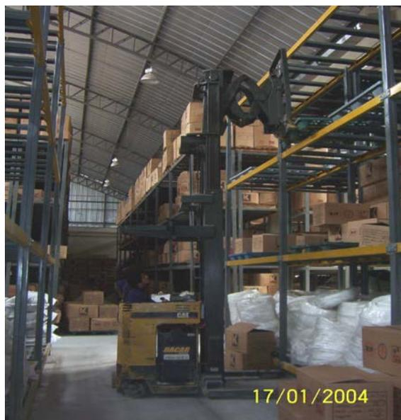
**Figura 4.19.- Montacargas de Doble Alcance**
