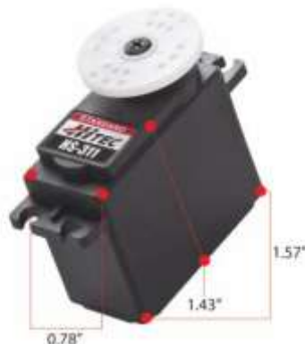
Figura 2.7: Características físicas del Servomotor estándar Hitec S311 [12].
