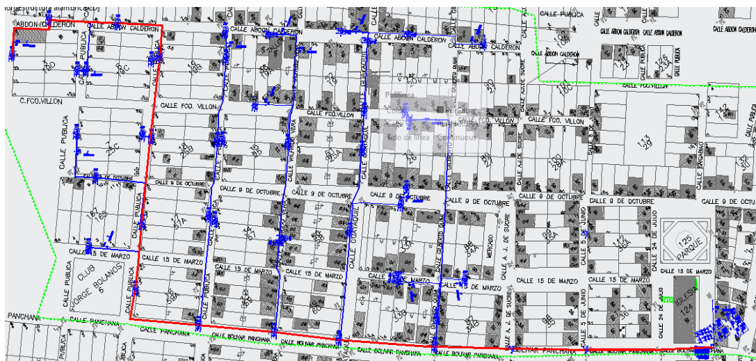
Figura 3.35 Primer cable de distribución del MT02
