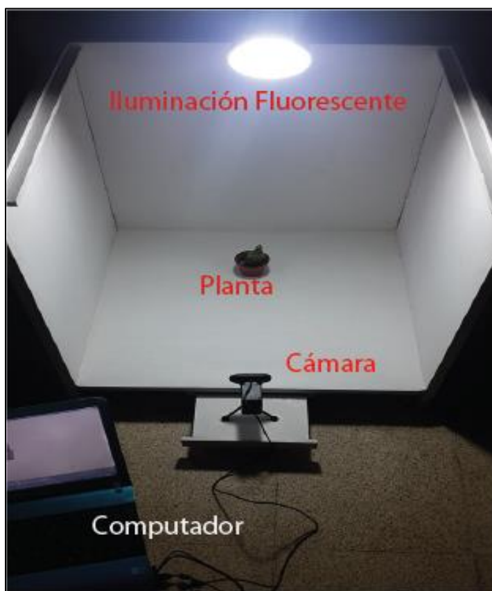
Figura 2.6: Descripción del equipo implementado.
