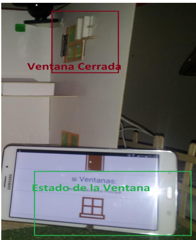
Figura 3.7: Prueba de sensor ubicado en la ventana
