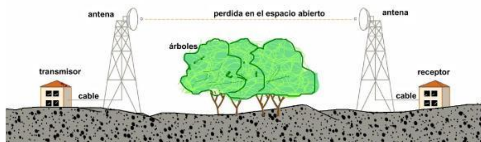
Figura 2.21: Pérdidas y Ganancias de un Enlace Inalámbrico.
