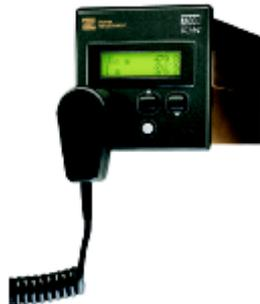
Figura 4.4.- Lector óptico acoplado al medidor.
