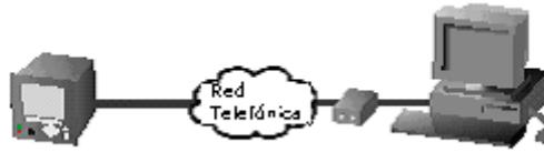
Figura 4.13.- Comunicación de un medidor vía Módem.
