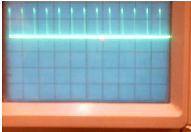
Fig.4.25 Curva Experimental del los Pulsos de Disparo del Tiristor de Conmutación.
