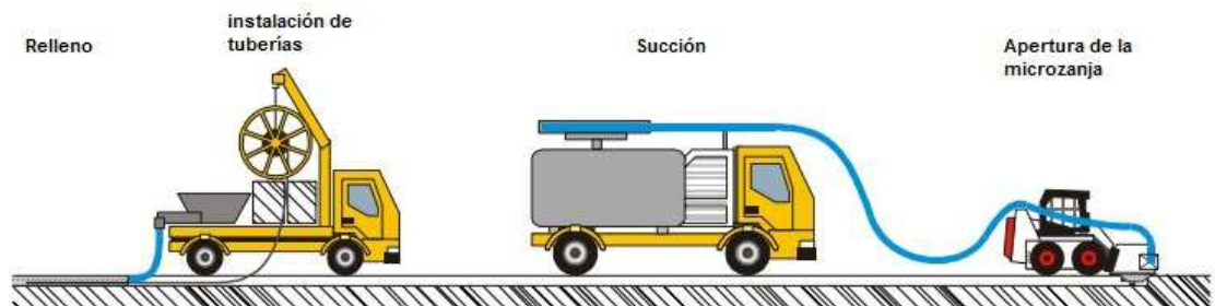
Figura H1. Procedimiento para el tendido de la fibra con la técnica de microzanjado Fuente: (39)
