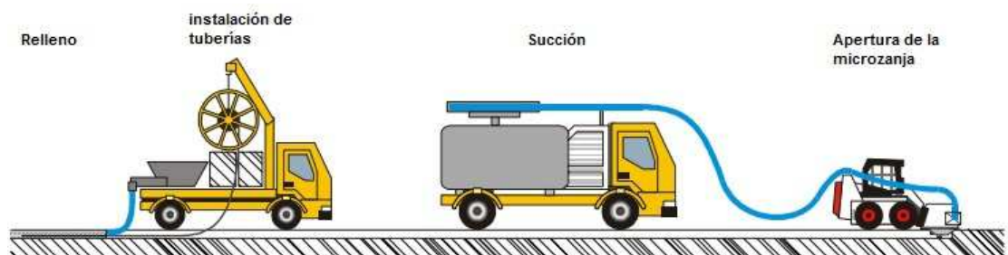
Figura H1. Procedimiento para el tendido de la fibra con la técnica de microzanjado Fuente: (39)
