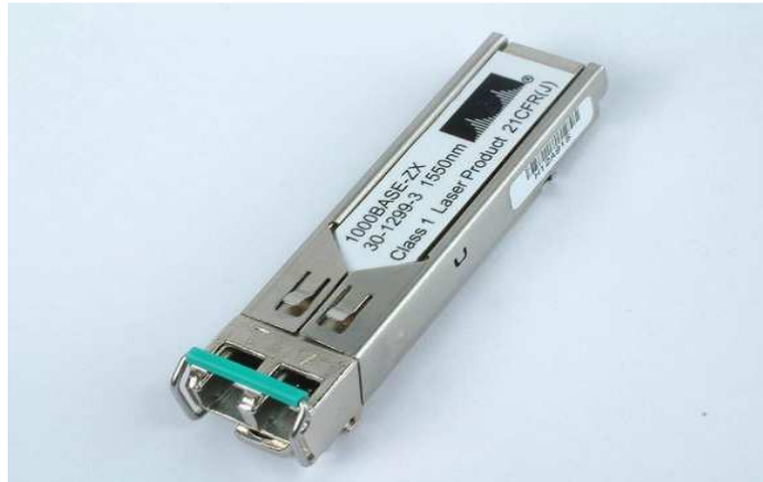
Figura 2. 13. Modulo SFP Cisco 1000BASE-ZX monomodo 9µm 1550nm 70Km conector LC Fuente: (28)
