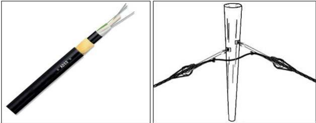
Figura 2. 10. Cable ADSS y detalle del montaje de los cables sobre los postes Fuentes: (24) (25)
