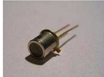
Un fototransistor es igual a un transistor común, con la diferencia que el primero puede trabajar de 2 formas:
