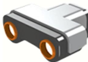
El sensor Ultrasónico sólo se incluye en el empaque de Lego Mindstorms NXT, y su principal función detectar las distancias y el movimiento de un objeto que se interponga en el camino del robot, mediante el principio de la detección ultrasónica. Este sensor es capaz de detectar objetos que se encuentren desde 0 a 255 cm, con una precisión relativa de +/- 3 cm
