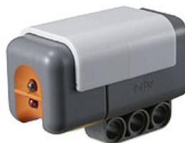
El sensor de luz permite tomar una muestra de luz mediante un bloque modificado que un extremo trae un conductor eléctrico y por el otro una cámara oscura que capta las luces. Esta cámara es capaz de captar luces entre los rangos de 0,6 a 760 lux. Este valor lo considera como un porcentaje, el cual es procesado por el bloque lógico, obteniendo un porcentaje aproximado de luminosidad.
