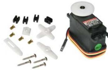
El motor del servo tiene algunos circuitos de control y un potenciómetro conectado al eje central del motor. Este potenciómetro permite a la circuitería de control, supervisar el ángulo actual del servo motor. El eje del servo es capaz de girar de 0 a 180 grados. Normalmente, en algunos llegan a los 210 grados, pero varía según el fabricante.
