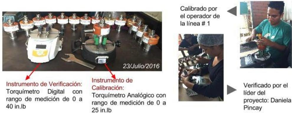
Figura 2.26: Calibración de cabezales para determinar frecuencia.
