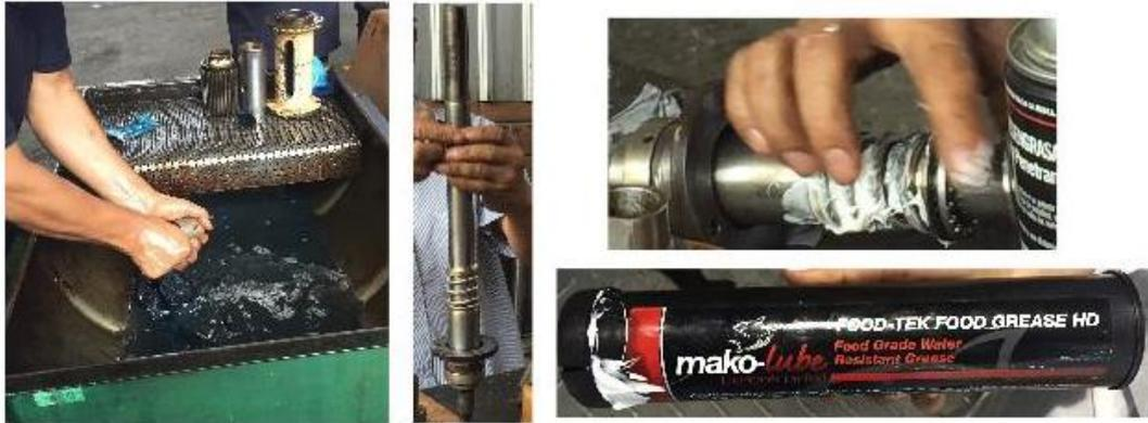
Figura 2.45: Limpieza y lubricación.
