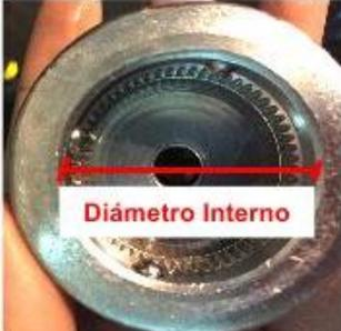
Figura A.57: Diámetro Interno de los chucks.
