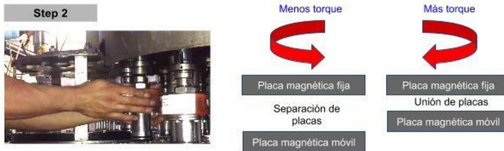
**Figura A.68: Calibración de roscador.**
