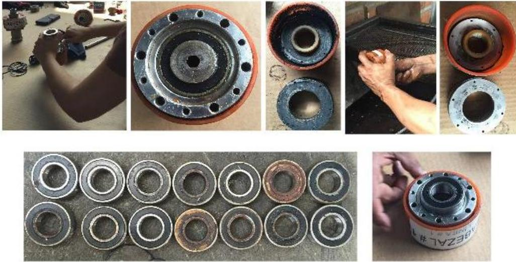
**Figura A.72: Cambio de rodamientos del roscador.**
