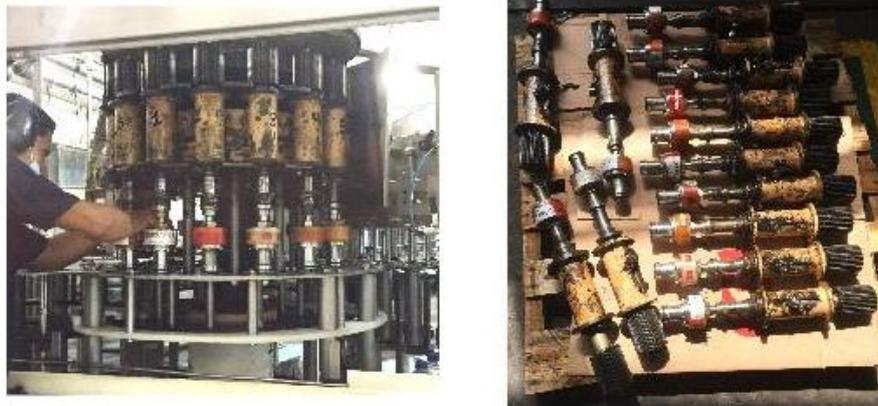
Figura 2.43: Desmontaje y traslado de cuerpos roscadores.
