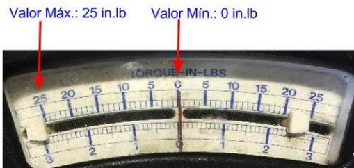
**Figura 2.7: Torquímetro Analógico Rango de medición de 0 a 25 in.lb.**
