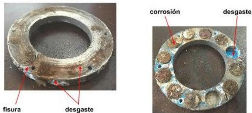
Figura A.39: Mal estado de las Placas Magnéticas.
