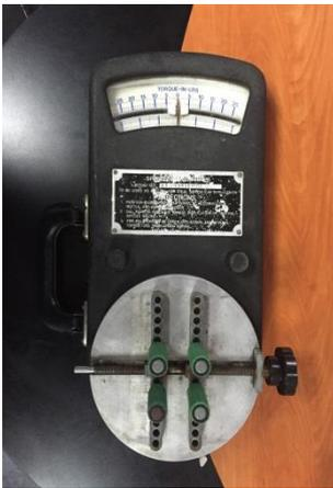
El Instrumento de medición del torque utilizado en el Departamento de Calidad es el torquímetro analógico con rango de medición de 0 a 25 in.lb, como se muestra en la figura 2.7:
