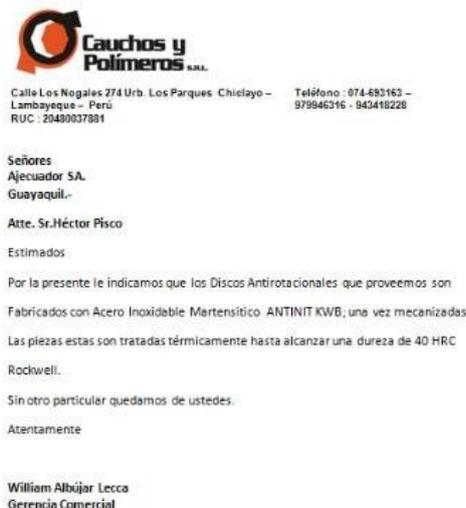
**Figura A.64: Prueba de dureza de los antirotacionales**
