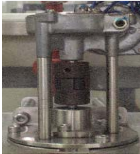
Figura 3.12 Acople mecánico del motor al agitador
