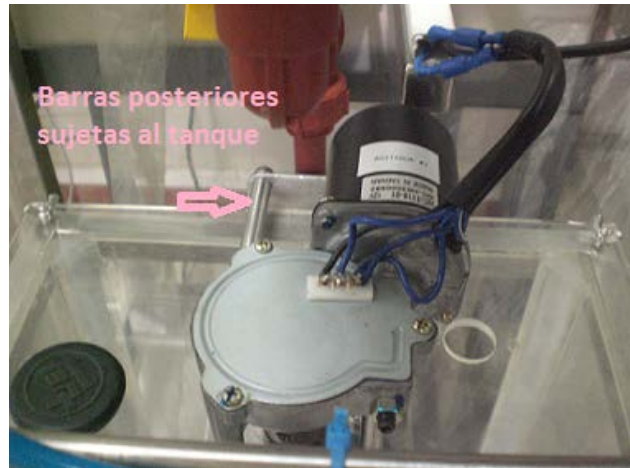
Figura 3.13 Vista superior del motor acoplado al agitador
