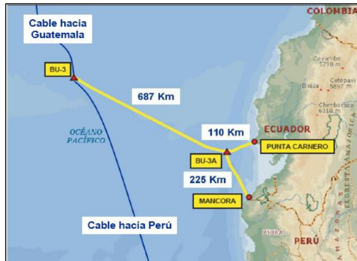
Figura 1.36 Conexión de Punta Carnero Ecuador y la redundancia desde Perú al cable submarino mediante fibra óptica (40)
