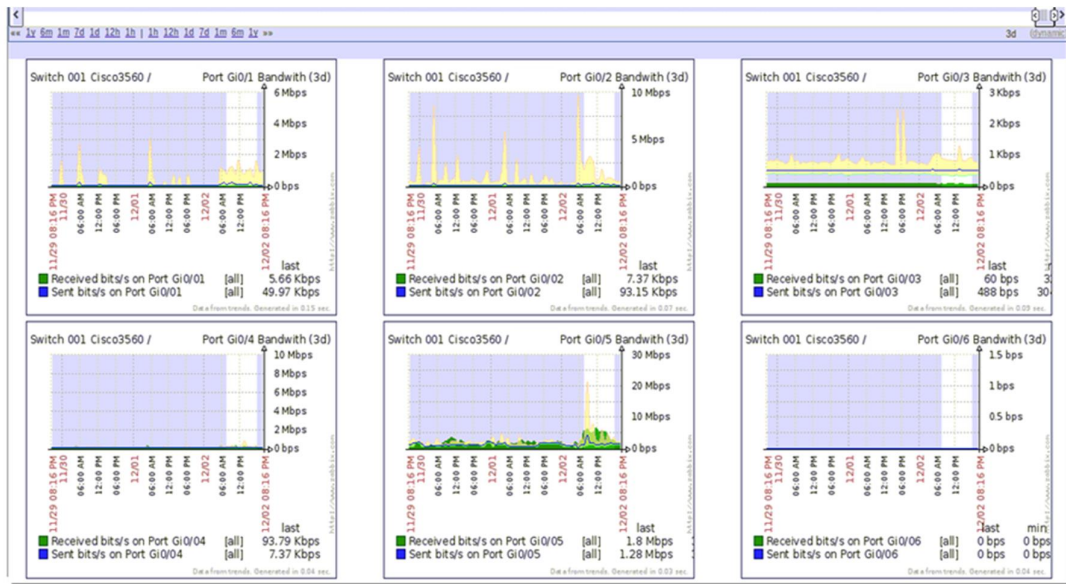
Figura 3.1 Monitoreo por puerto Switch CISCO 3560
