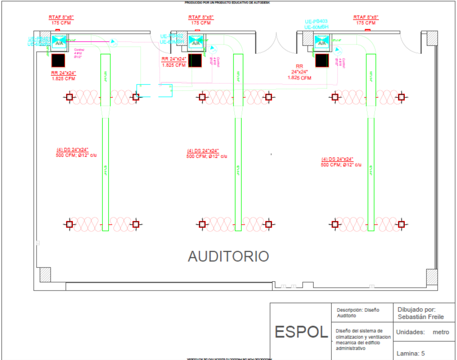
Plano 6 Sistema de climatización auditorio
