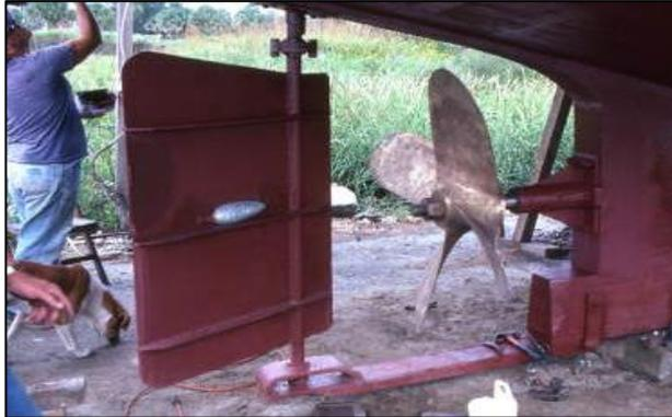
**Figura 2.3 Conjunto hélice y timón direccional**
