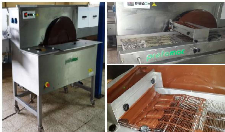
FIGURA 2.3 BAÑADORA TEMPERADORA FUENTE: INGRID LUCIN
