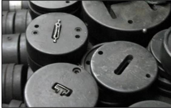
**Figura 2.5 Boquilla que da forma a pieza final.**
