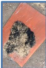
6. Remover las cenizas del interior del reactor volteando la estufa, a fin de evitar taponamientos por ceniza en los agujeros de la plancha del reactor
