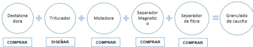
**Figura 5 . Maquinaria principal en una planta de trituración**
