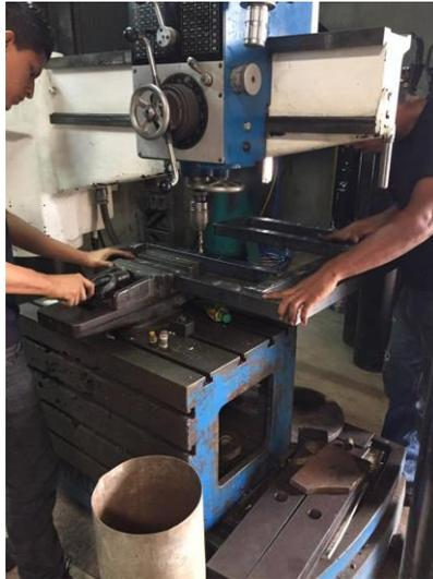
**Figura B5.- Taladrado del chasis para colocación de chumaceras.**
