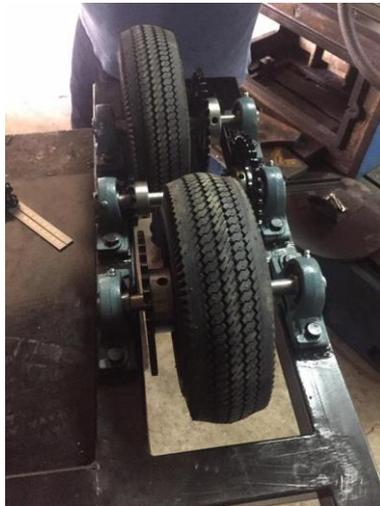
**Figura B7.- Montaje del sistema de transmisión.**
