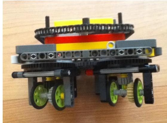
**Figura 1.6.-Diagrama de locomoción síncrona**
