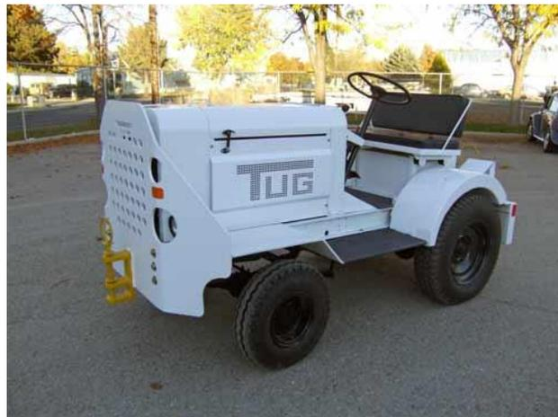
**Figura 1.1.-Tractor remolcador**
