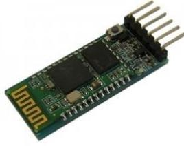
**Figura 1.13.-Adaptador arduino a conexiones Bluetooth hc-05**
