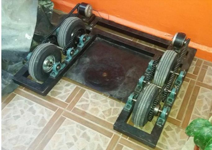
**Figura B8.- Montaje final del sistema de transmisión**
