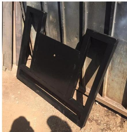
**Figura B4.- Bastidor con placa central soldada.**
