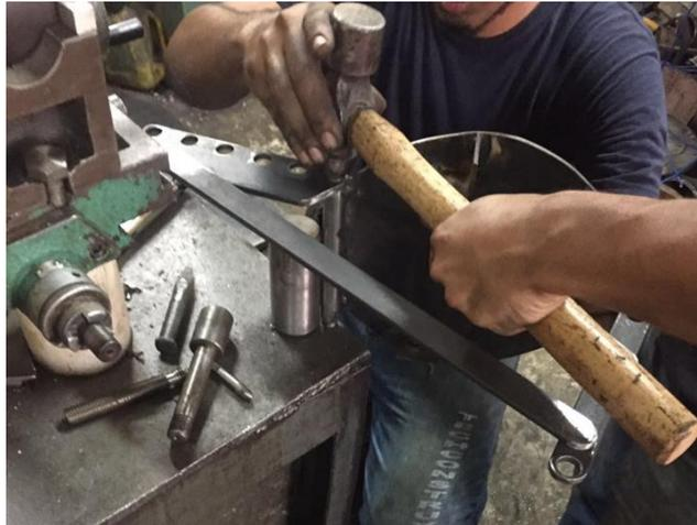
**Figura B9.- proceso de remachado en las uniones móviles del seguro del tren delantero.**
