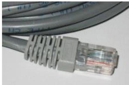
**Figura 1.12.-Cable ATP usado en conexiones de Ethernet**
