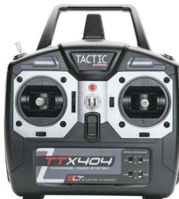
**Figura 1.11.-Mando de radio frecuencia.**
