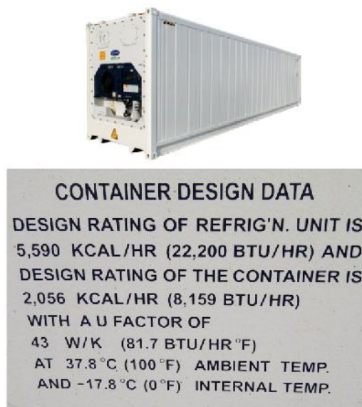
Figura 2.1 Especificaciones de diseño de contenedor refrigerado 40FT marca: QUINDAO
