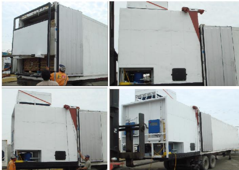
Figura 5.1 Colocación de la unidad de enfriamiento rápido en un contenedor de 40 pies
