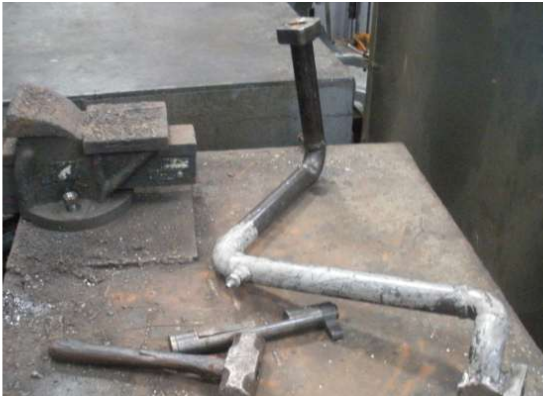
Fig. 2.4 Tubería re soldadas causa de 80% de fallas, en el año 2.013
