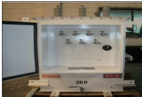
Figura 8. Transformador Primario o Reductor. Fuente: "REDA", Schlumberger (Schlumberger, 2016).
