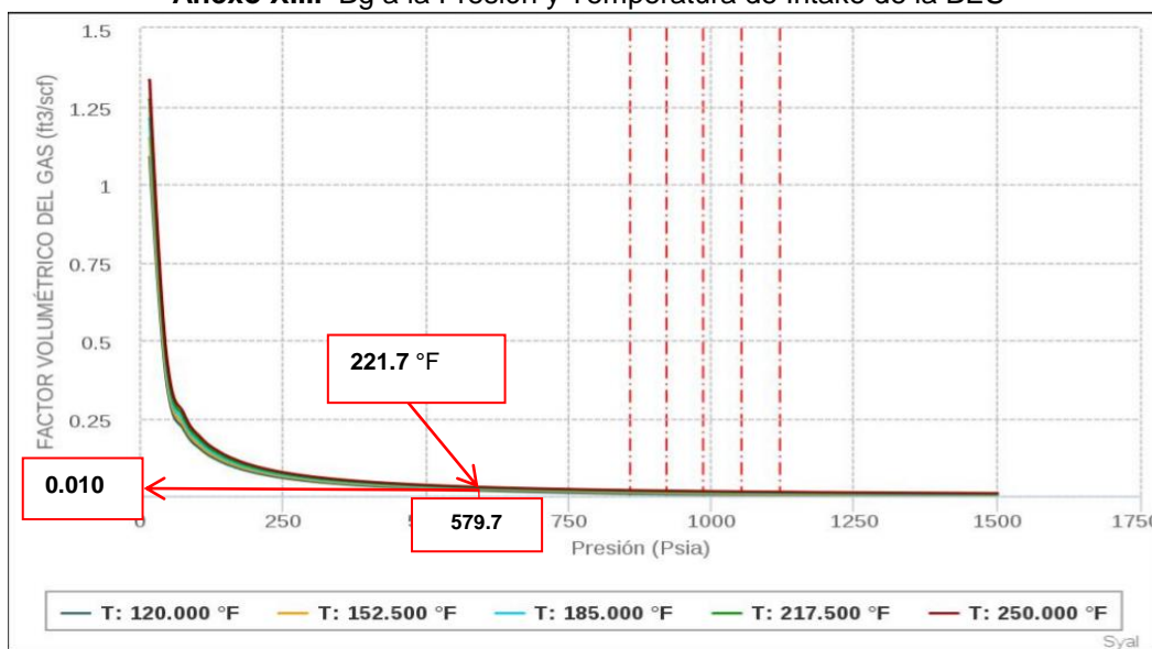
Anexo XIII. Bg a la Presión y Temperatura de Intake de la BES
