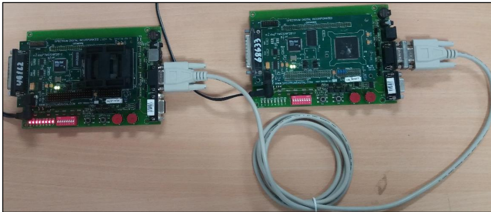
Figura 4.151 Ejecución de la práctica sobre comunicación CAN
