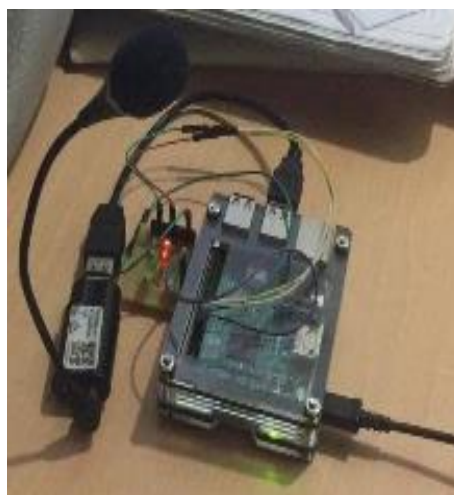
Figura 3.5: Led Rojo indica que se guarda en base de datos
