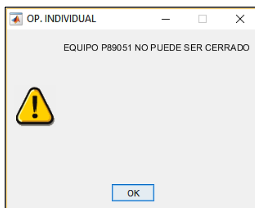
Figura 3.57: Cierre de seccionador P89051 sin IED disponible.
