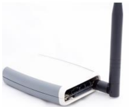
Figura 4.3: Zolertia Z1SP con antena externa incorporada [40]
