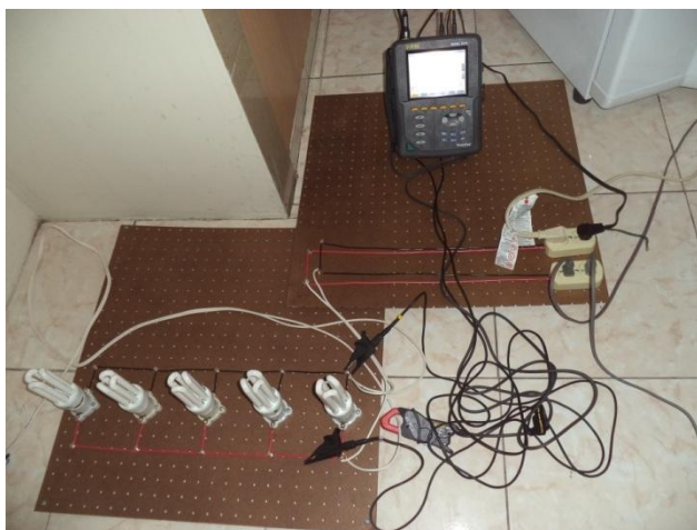
Figura 1.12: Montaje del Banco de Pruebas para TEST 2 con Power Pad AEMC
