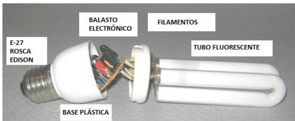
Figura 1.1: Elementos constitutivos de una CFL (Adaptación del autor de imagen recuperada del sitio web Afinidad Eléctrica http://www.afinidadelectrica.com.ar/articulo.php?IdArticulo=133 , 2015) [7]
