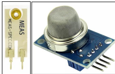
Figura 4.6 Sensores de vibración y humo respectivamente.
