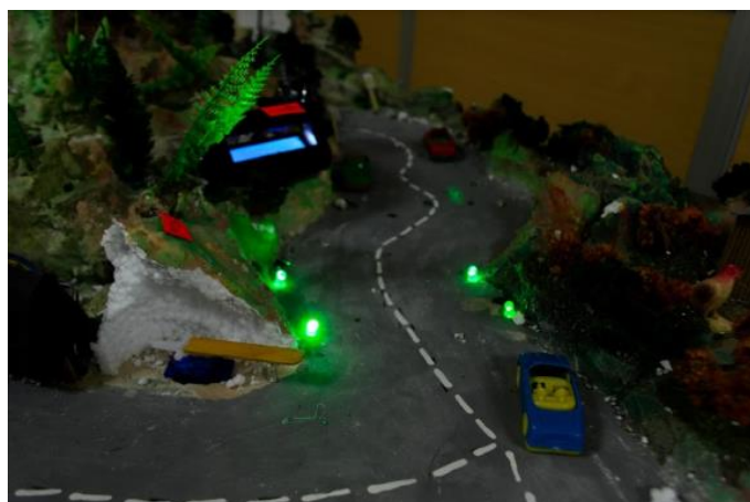
Figura 4.4 Indicadores led ubicados al inicio de cada tramo de los carreteros, forman parte de la carretera reactiva.
