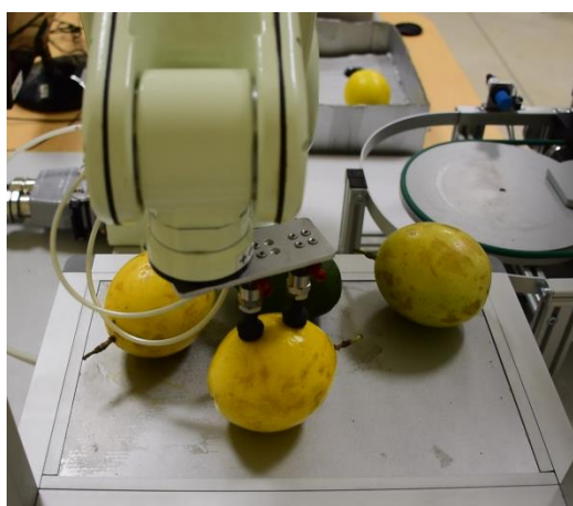
Figura 3.11: Posición y orientación de la herramienta durante el agarre de las frutas
