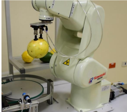
Figura 3.12: Robot en proceso de traslado de la fruta
