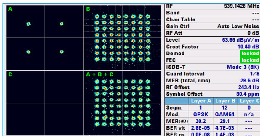
Figura 4. 60 Diagrama de constelación del punto 11.
