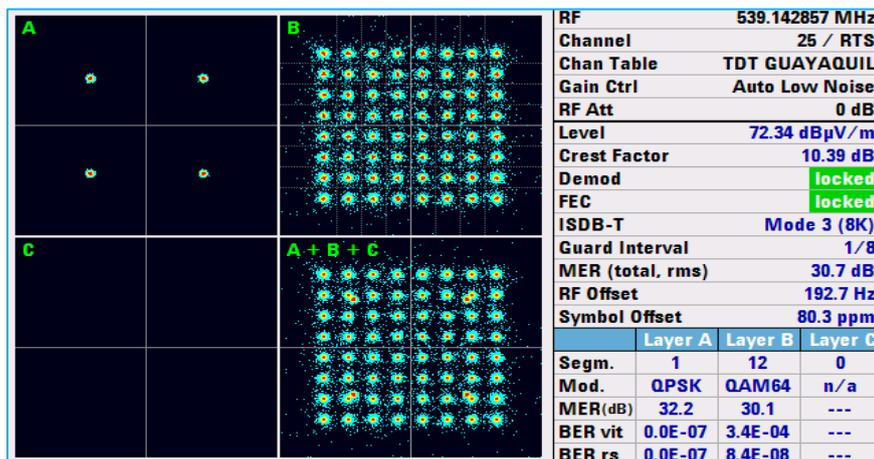
Figura 4. 53 Diagrama de constelación del punto 4.
