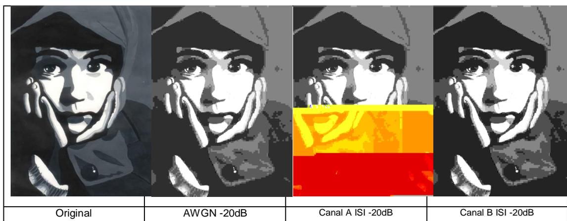
**Figura 26. Comparación de Imagen Original vs Recibida ingresando un SNR 20dB en cada Canal**
