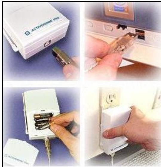
Figura 2.2.1.1b - Conexión del programador PC
